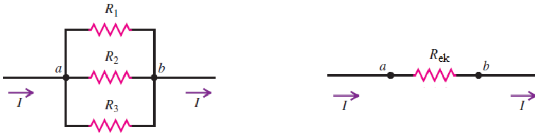
Gambar 6.2. Resistor dalam rangkaian paralel dan resistansi ekuivalennya.
